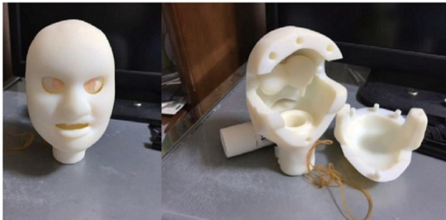
図5 3Dプリンタによる頭部の造形と眼の可動部（三番叟）
