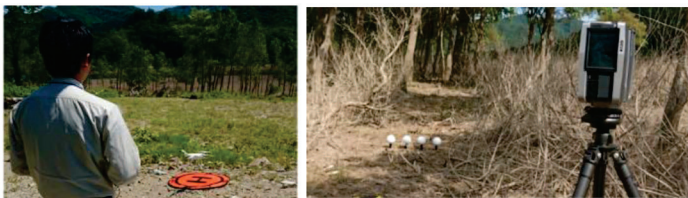
図3 水没林ドローン・地上レーザー計測
