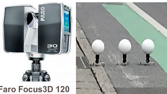
図2 レーザー計測装置 と 識別白玉
