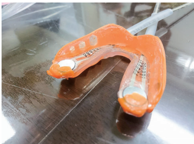
図3 スポーツ用マウスピースのフレームに張り付けた圧力センサとステンレス板(試作2号機)
