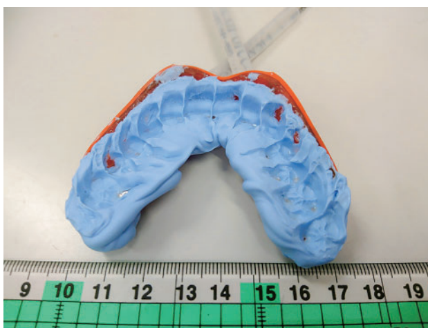
図4 マウスピース型咬合センサ試作2号機
