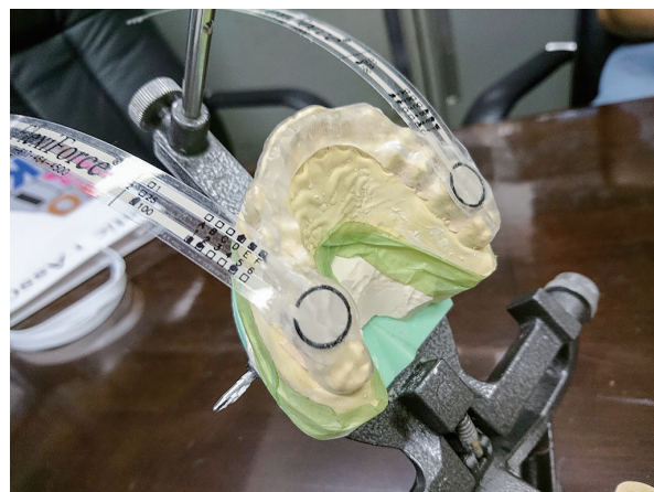
図2 FlexiForce A201を接着したマウスピース型咬合力センサ試作1号機
