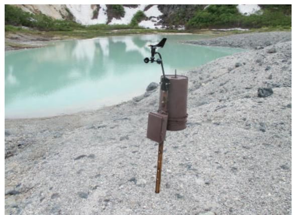
図3 硫化水素センサーの設置状況（昭和湖）
