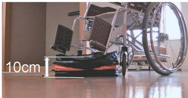
図3 圧縮時の試作人工革製クッション
