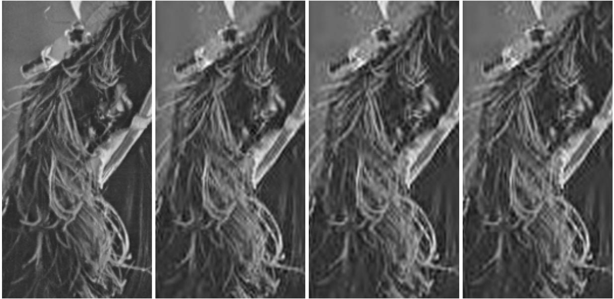
(a) 原画像 (b) 空間-周波数領域の最適分割 (33.45[*dB*]) (c) レート歪み理論に基づいた最適帯域分割 (32.01[*dB*]) (d) Wavelet Packet (32.35[*dB*])
