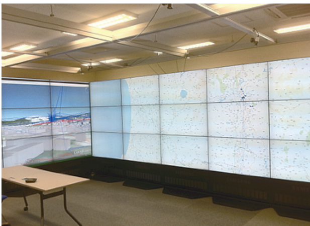
図7 i-MOS 3次元実験室でのセンサ情報の可視化 (左: 3次元表示 右: google map の連結表示)
