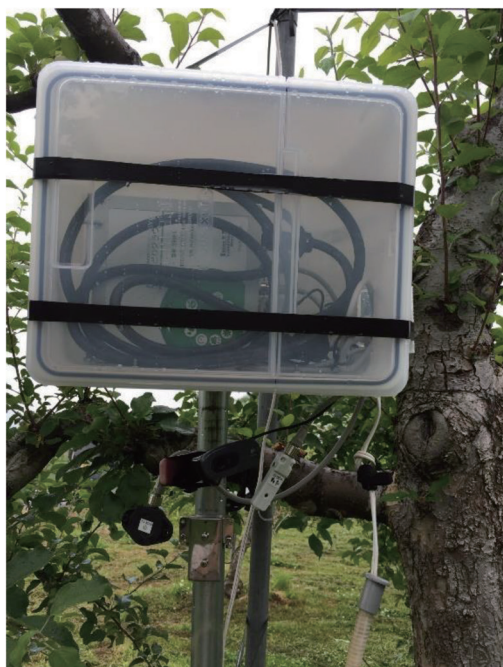
図6 リンゴ農園に設置した「みどりボックス」と温湿度センサ、日射量センサ (2017年6月25日設置)
