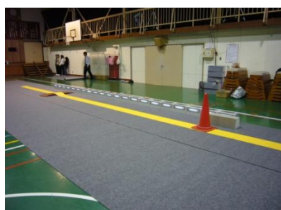
写真1 実験装置1(自発光型縁石ブロック)
