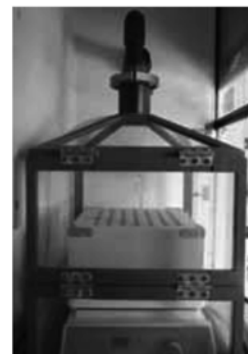
図5 専用小型フードに収納されたホットプレートとヒートブロックおよび上部に設置した箱型カバー
