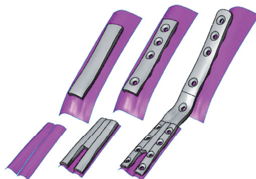
図 12 サーフェス上での骨折プレート設計
