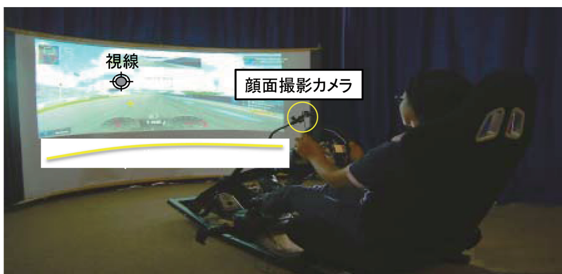
図6 本研究の安全運転支援システムのために制作したカーシミュレータ
