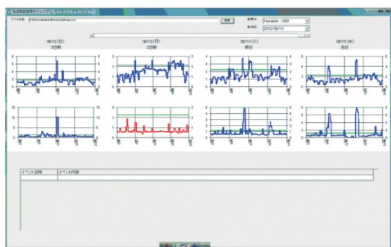
図2：ビューワで積分法（上側）と累積度数分布法（下側）の2つの方式での判定結果がグラフで表示されたみまもり画面の例
