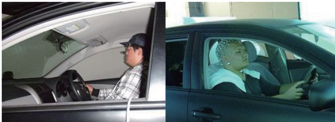
図③-2 眼球運動計測装置（左）と脳波計測装置（右）
